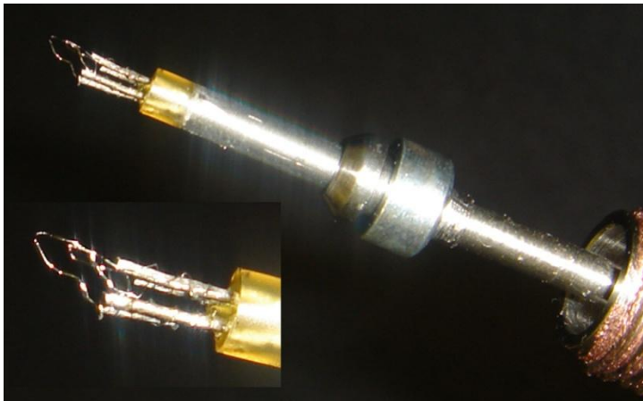
0.05 mm thermocouple pairs
